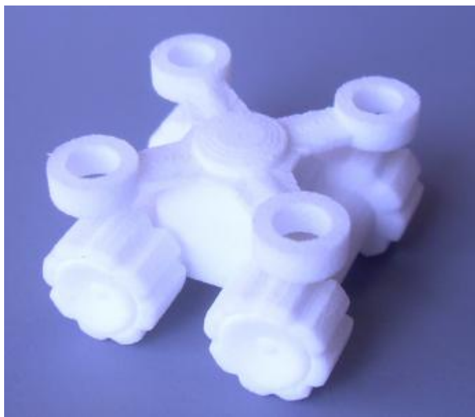
Figure 16 : Zoom sur un des boogies, notez les lignes dûes à la méthode d'impression.
