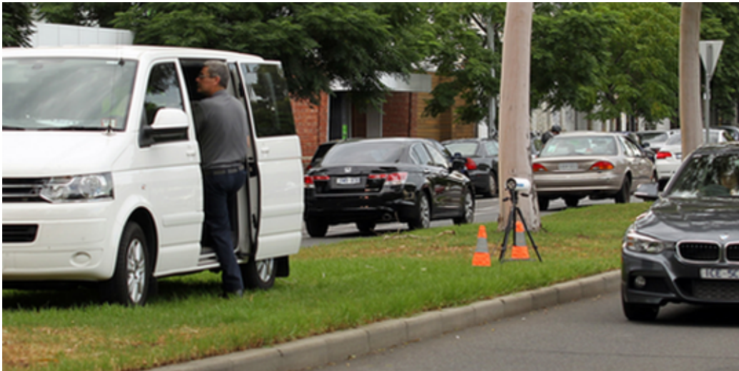
Le système existant qui scanne les plaques minéralogiques avec une caméra fixe
